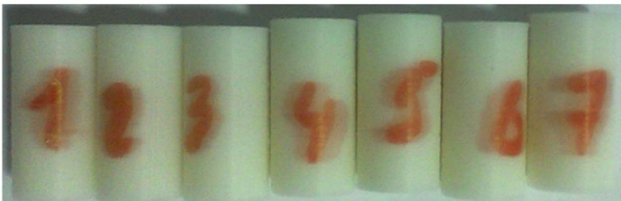
Фотографии элементарных образцов REC ABS до испытаний
