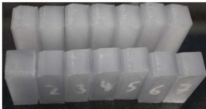
Фотографии образцов REC RELAX после испытаний
